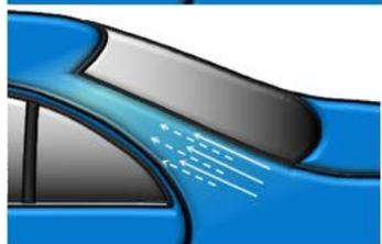
Miscelare qualsiasi trasparente Standex 2K secondo la rispettiva TDS. Sopraverniciare Standoblue o Standohyd Plus Basecoat con trasparente Standex VOC pronto all'uso. Sfumare il trasparente in mani ben ripartite con pressione ridotta a nell'area carteggiata
