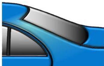
Carteggiare l'area di sfumatura e di transizione su vecchi lavori integri, e.g. con 3M Trizact P3000 Fine Finishing Disc o abrasivi simili di altri fornitori.
