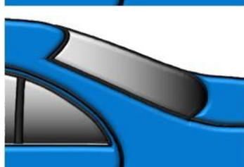
Carteggiare l'area di sfumatura e di transizione su vecchi lavori integri, e.g. con 3M Trizact P3000 Fine Finishing Disc o abrasivi simili di altri fornitori.
