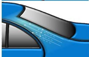
Appicare Smart Blend puro in diverse mani leggere con pressione ridotta nell'area di sfumatura. Dissolvere l'overspray e levigare l'area di transizione di Standex VOC Clear e restare all'interno dell'area sfumata, carteggiata con P3000.
